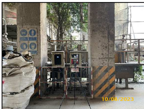
ภาพที่ 3.57 การตรวจวัดความร้อน บริเวณ SP Boiler 5-1 ชั้น 1
