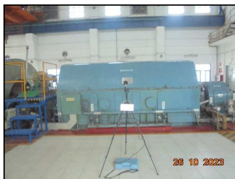
ภาพที่ 3.48 การตรวจวัดระดับเสียงของ เครื่องจักรบริเวณเครื่องกำเนิดไฟฟ้า
