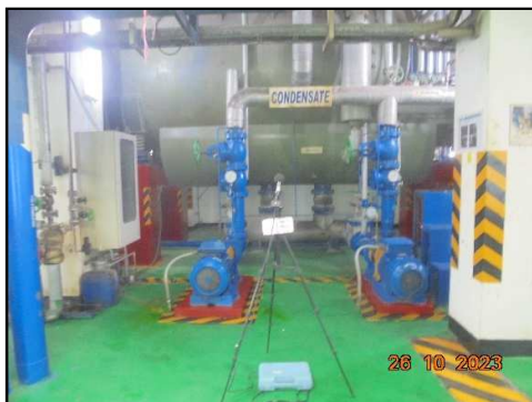
ภาพที่ 3.45 การตรวจวัดระดับเสียงของเครื่องจักร บริเวณปั๊มท่อส่งไอน้ำ
